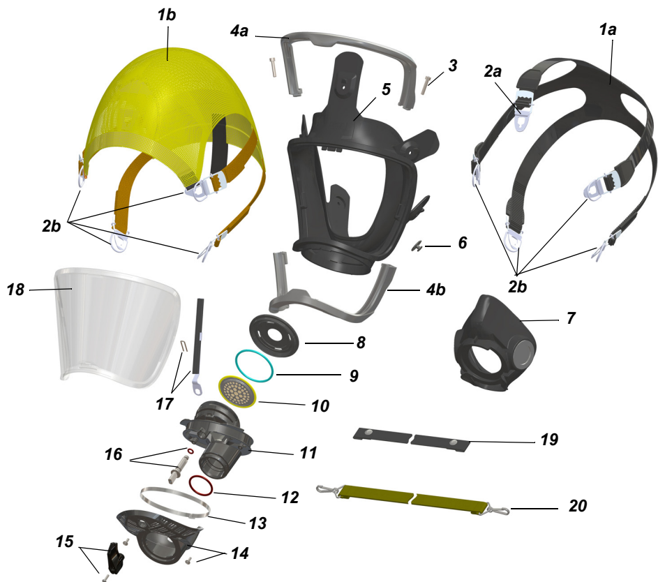
图 6 Facepiece G1 AirElite 分解图
